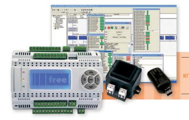
FREE EVOLUTION EVD 7500/C/U CONVERTIDOR USB/RS485 **KITEVOLUTION** TRANSFORMADOR PARA ALIMENTACIÓN FREE FREE STUDIO
