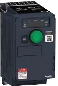
(1) La frecuencia de conmutación es ajustable desde 2 hasta 16 kHz, valor nominal: 4 kHz. Para funcionar con frecuencias de conmutación superiores al valor nominal. Es necesario aplicar una desclasificación a la corriente del variador (salida). En tal caso, es posible reducir la frecuencia de conmutación si la temperatura sube en exceso.
